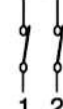
F 2 Contacts N.F. - N.F. Contact n°1 Fermé au Repos Contact n°2 Fermé au Repos
